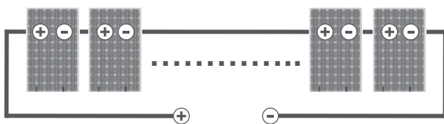
Reihenschaltung für mehr Spannung
