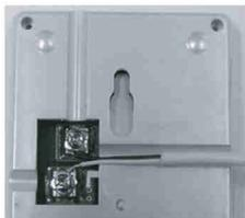
**Schritt 5.** Integrieren Sie den Ferntemperatursensor mit den Schrauben in der Reihenfolge der Pfeile.
