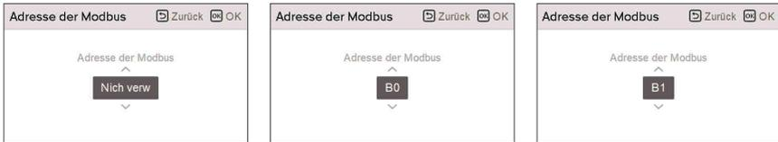
Es gibt 2 Optionen in dieser Funktion, Modbus-Adresse und Gerät. Wenn Sie die Modbus-Adresse-Option aktivieren, wählen Sie eine Adresse (B0 oder B1) oder nicht nutzen. Dann stellen Sie den Port und die Spezifikation in den Bereich von 0000.0~9999.9 [Impuls/kWh], wie in der nachstehenden Abbildung, ein.
